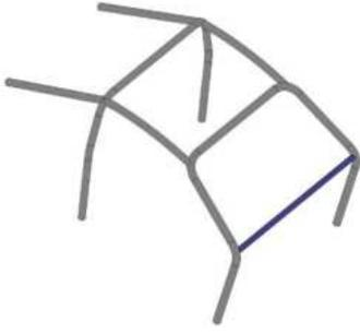
Se podrá sustituir por extensiones hacia los montajes superiores de la suspensión delantera en forma una "X" según dibujo
