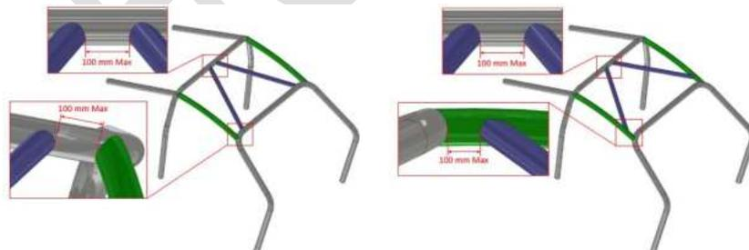
Los extremos de los refuerzos de techo deben estar a menos de 100 mm de la unión entre las barras antivuelco y los miembros (no aplicable a la parte superior de la V formada por refuerzos que deberán estar a una distancia máxima de 100 mm en ese lugar)
